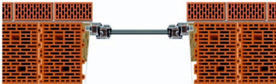
Установка окна в однородную стену с облицовкой кирпичом, оконная коробка шириной меньше 150 мм
