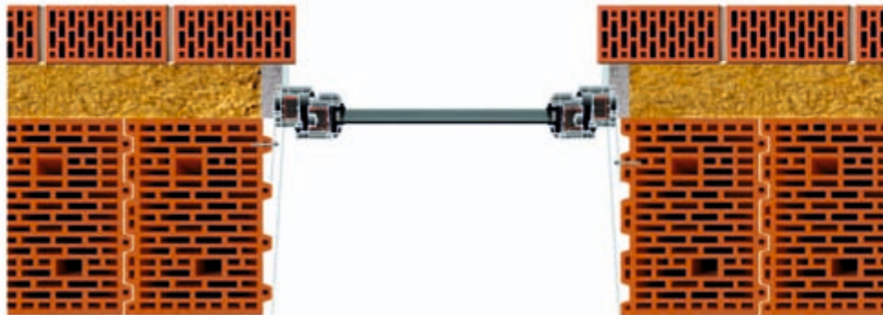
Установка окна в стену с наружным утеплением
