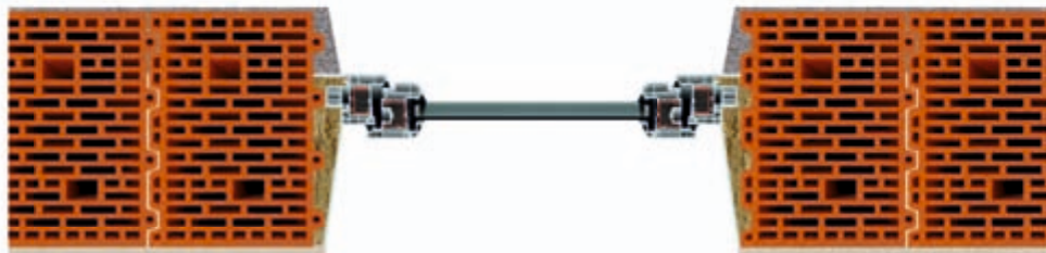
Установка окна в однородную оштукатуренную стену, оконная коробка шириной 80 мм и меньше
